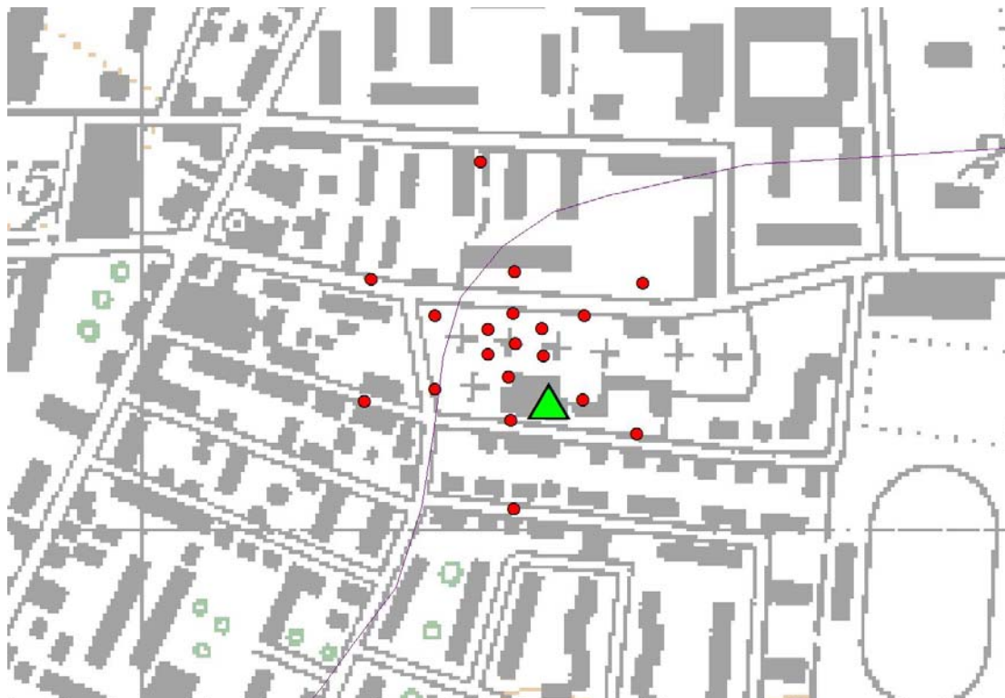
Abbildung 2. Angewandte Arraygeometrien bei der Station SBIF (rote Punkte). Die Lage der Starkbebenstation SBIF ist als grünes Dreieck eingezeichnet.
