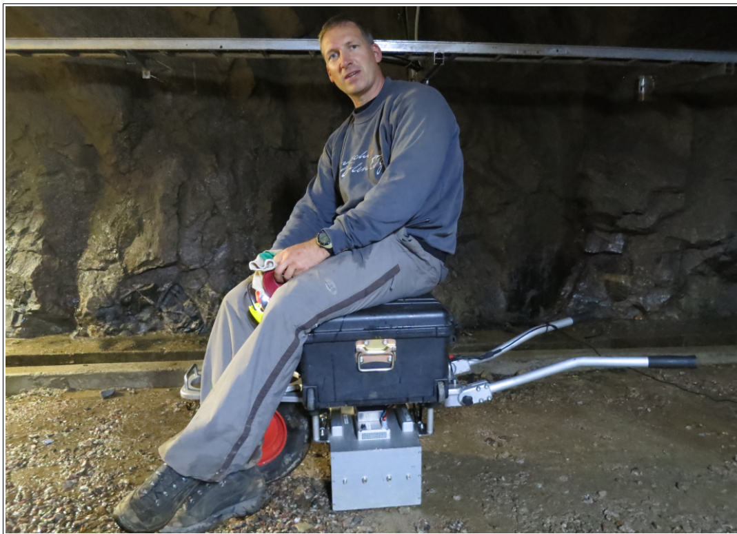
Fig. 3.25 Vibroseis-Quelle EViS im Stollen auf dem Profil 13METMA3.
