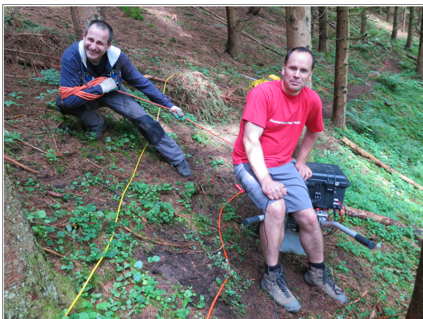
Fig. 3.1 Seismische Vibro-Quelle ELViS im steilen Gelände im Einsatz.
