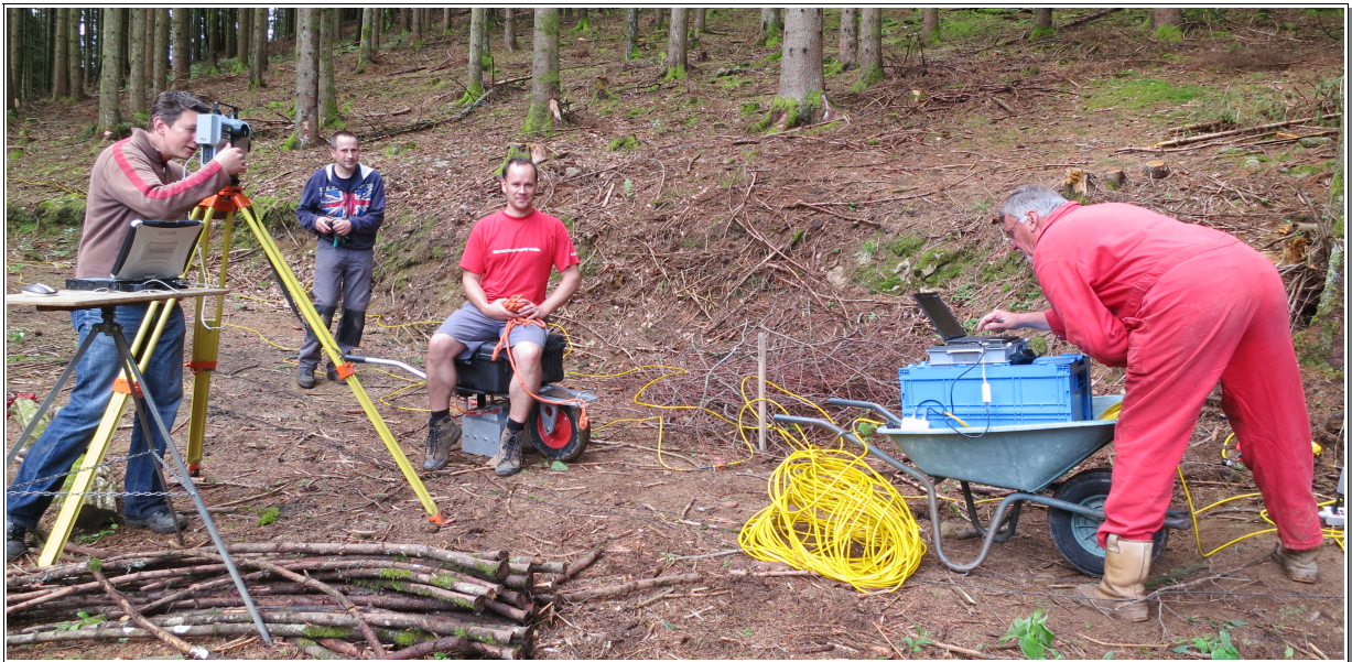
Fig. 3.10 Feldarbeiten bei seismischen Untersuchungen (von links): geodätische Vermessung, Begutachtung durch den bird dog, seismische Anregung und Aufzeichnung der seismischen Signale mit Qualitätskontrolle.
