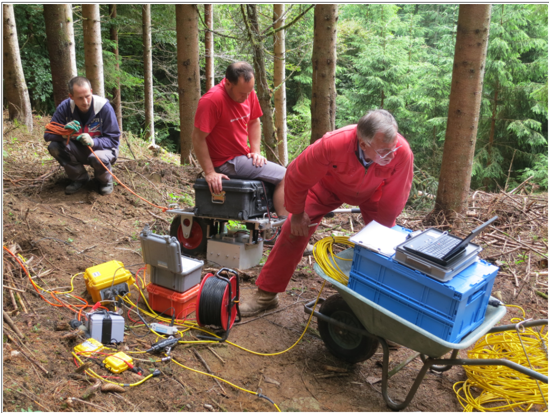
Fig. 1.2 Manchmal ist auch bei seismischen Feldarbeiten Sitzen gefragt: Die zusätzliche Belastung der Scherwellen-Vibratorquelle (Bildmitte) setzt sich der Operator während des Sweeps auf die Quelle. Damit wird die Kopplung an den Untergrund verbessert.
